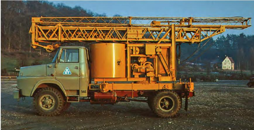
Schon Ende der 1950er-Jahre hat unser Firmengründer Hans Liebherr erkannt, dass ein möglichst mobiles Kransystem große Vorteile bietet und mit der KA-Serie einen kleinen Turmdrehkran auf LKW-Chassis fertigen lassen. Die KA-Fahrzeuge besaßen einen leeren Tank, der zum Ballastieren auf der Baustelle einfach mit Wasser, Kies oder Sand befüllt werden konnte. Diese frühen fahrbaren Baukrane zeigen, dass uns ein hoher Praxisbezug schon immer wichtig war.
