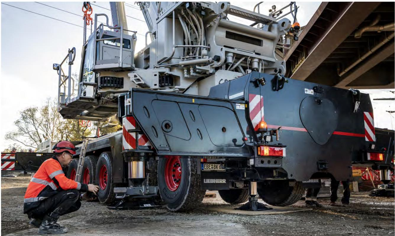
“In dreißig Minuten steht der Kran auf seinen vier Stützen.“ BKL-Mitarbeiter und Fahrer Steffen fährt nach getanem Job per Fernsteuerung die Kranabstützungen in den Schiebehelmkasten. Unter dem Heck ist deutlich der fünfte Abstütz-Zylinder zu erkennen. Der LTM 1650-8.1 erledigt die Montage des Abstützkastens selbst und benötigt keinen Hilfskran dafür.
